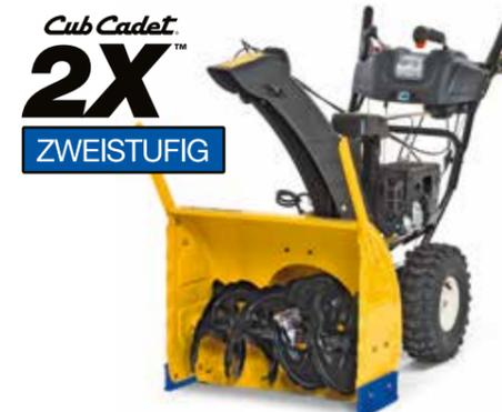
Die 2X Series beseitigt den Schnee im 2-Stufen-Verfahren. Die erste Stufe bildet eine quer liegende Fräseinheit, bestehend aus mehreren X-Segmenten. Durch ihre gezahnte Form beißen sich diese Segmente mühelos auch durch verharschten Schnee und ziehen diesen in das Fräsgehäuse ein. Die zweite Stufe ist ein schnell drehendes Propeller-rad, welches den eingezogenen Schnee kraftvoll durch den Auswurf-schacht bläst.
